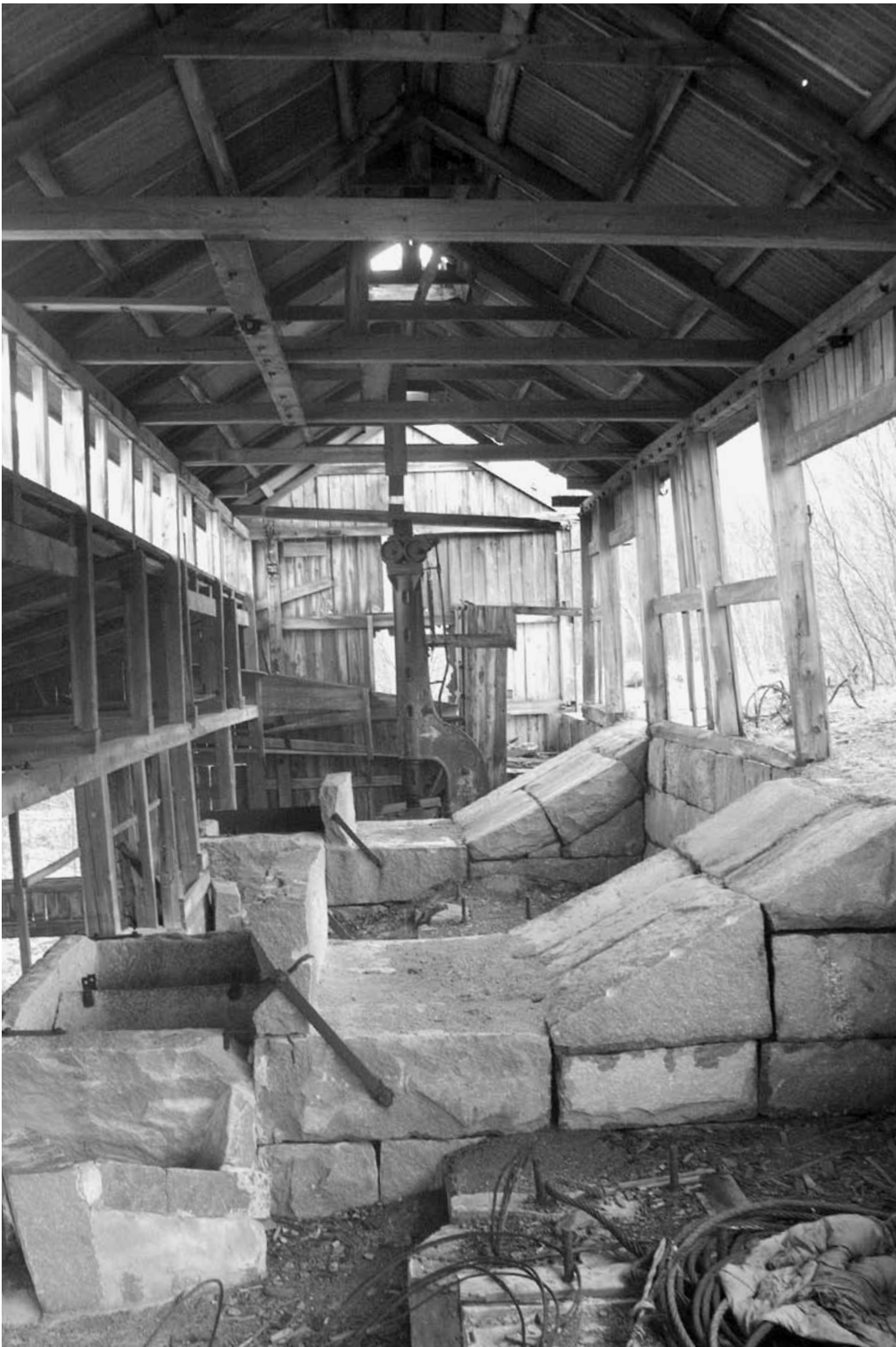
Ill. 17. Interiör från knottfabriken vid Lahälla tagit 2007. I fabriken finns en spaltmaskin kvar, längst bort i bild. Spaltmaskinen var ett sätt att mekanisera produktionen av gatstenar. De flesta av dessa försök blev mycket kortlivade då den tänkta lönsamheten oftast uteblev. Trots detta byggdes fabriker på flera platser i Bohuslän. De kan därför ses som ett ideologiskt uttryck för industrialismen och kapitalismens tanke om arbetsuppdelning och mekanisering av arbetsprocesser. Fabriken i Lahälla är den sista kvarvarande och förhållandevis intakt. Fasad och tak är i behov av renovering. Trots allt borde fabrikslokalen med en rimlig insats kunna renoveras och förvaltas som en del av ett framtida reservat. Dess symboliska värde, precis som ett Folkets hus, utgörs av ett materialiserande av tankar och idéer.
